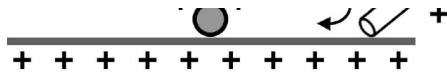
[그림 9] 사전실험: 맞닿은 평행판과 금속공에 대전체를 접근시켜 유도 대전량을 측정 → 평행판 : 금속공 = 9 : 1.
