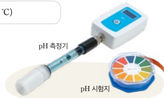
그림 IV-3 pH 측정기와 pH 시험지
