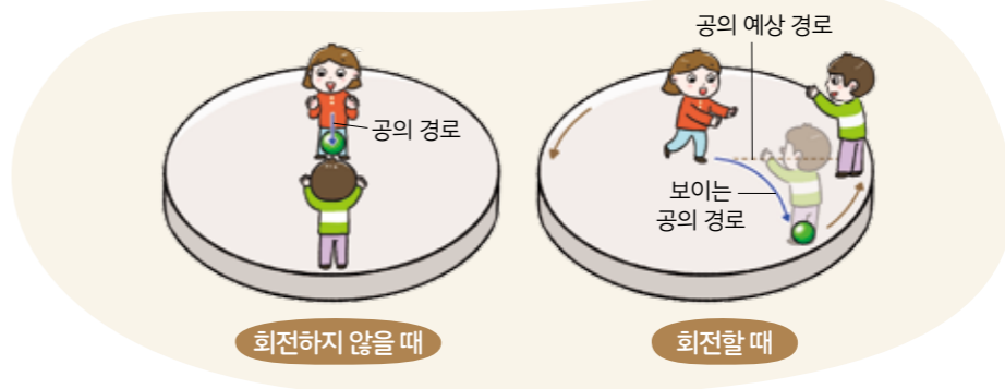
그림 II-5 전향력의 작용 회전 원반 위에서 물체를 던지면 물체의 이동 방향이 휘어지는 것처럼 보인다.
