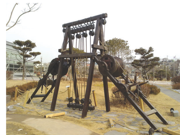
▲ 정약용이 고안한 거중기는 도르래의 원리를 이용해 만든 도구로, 수원 화성을 쌓을 때 이용되었다.
