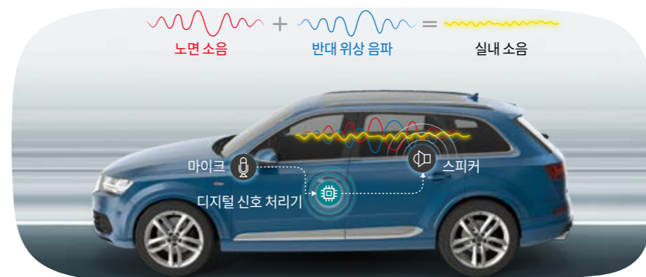
그림 III-25 자동차 내부의 능동 소음 제어
