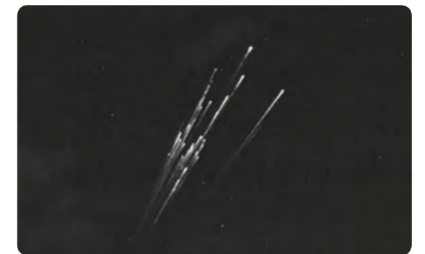
그림 I-10 궤도 진입에 실패한 인공위성 2022년 2월 3일 미국에서 발사된 인공위성 중 다수가 태양풍에 의한 지구 자기장 교란으로 궤도 진입에 실패해 대기권으로 추락했다.
