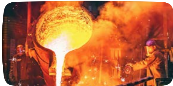
그림 II-1 철의 제련 용광로에 산화 철(III)이 주성분인 철광석과 함께 코크스(C), 석회석(CaCO 3 )을 넣고 가열한 공기를 불어 넣으면 코크스가 연소하면서 일산화 탄소가 생성된다. 이 일산화 탄소가 산화 철(III)을 환원시킨다.
