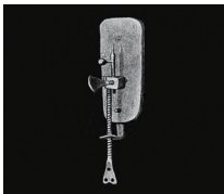
〈그림 1-4〉 레이우엔훅의 현미경 유리를 녹여 만든 렌즈를 고정하여 미생물을 관찰하였다.
