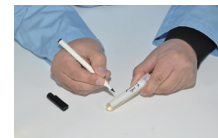
〈그림 Ⅲ-23〉 시험관에 균주명, 접종일, 배지명, 실험자를 적는다.
