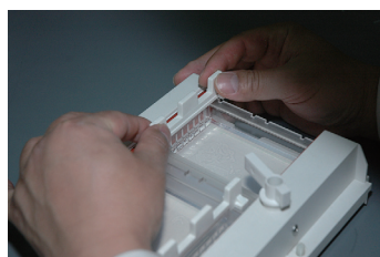
〈그림 III-41〉 굳은 겔에서 콤 제거하기, 전기영동장치 장착
