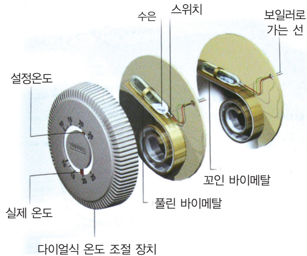
〈그림 IV-41〉 자동 온도 조절 장치(원하는 온도를 설정해 두면 주변 온도에 따라 바이메탈이 풀리거나 꼬여서 보일러는 조절한다.)
