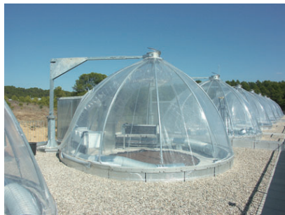
〈그림 V-72〉 에코트론(Ecotron) 영국 실우드 파크에 설치된 생태연구 시설
