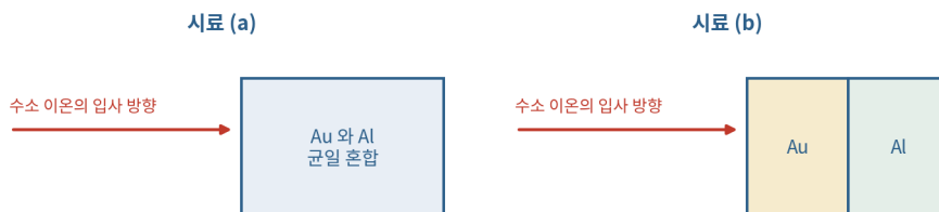
[그림 3] 시료의 구조 및 수소 이온의 입사 방향
