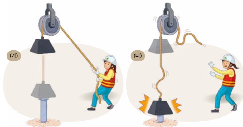
그림 I-30 높은 곳으로 들어 올린 추가 낙하해 말뚝을 박는 일을 하는 모습
